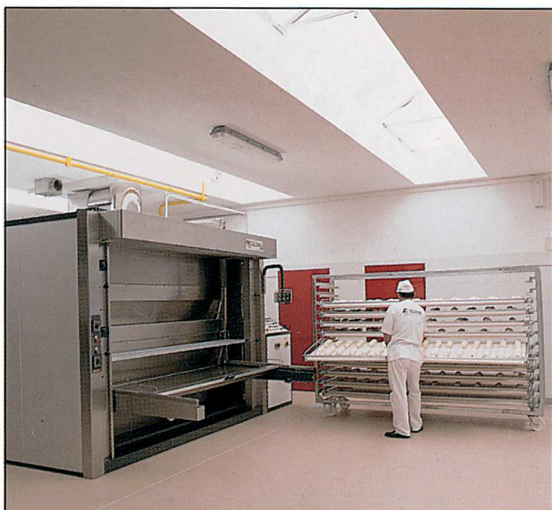
Infornamento a telai con un solo operatore Setter loading with only one operator.
